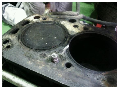
折れたヘッドボルトとグラインダの傷(中央)
